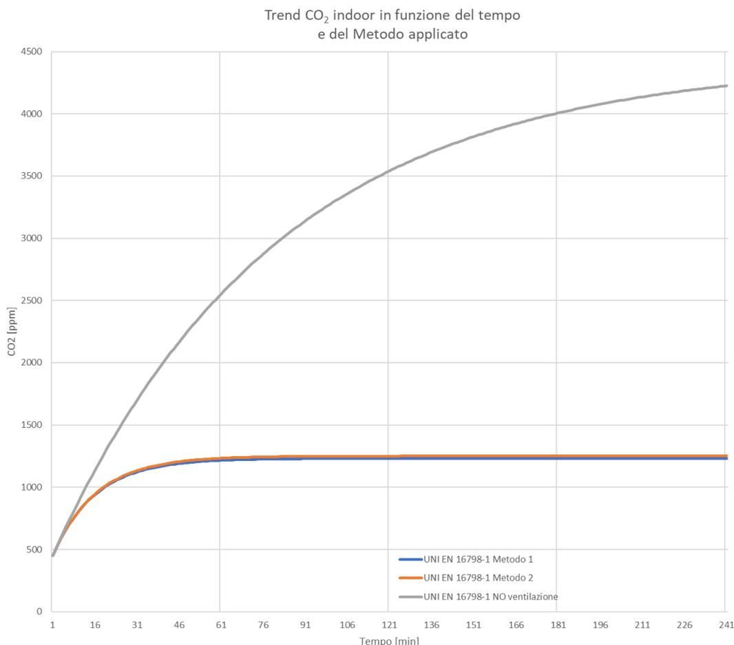
La linea grigia rappresenta l'andamento, calcolato sempre con lo stesso modello di calcolo, se nell'ambiente la ventilazione fosse affidata esclusivamente ad al trafilamento e all'aerazione naturale in grado di produrre un ricambio medio pari 0.8 vol/h
